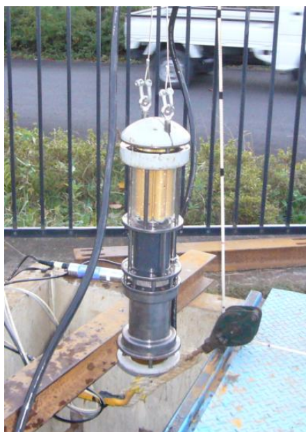
B. nano 発生装置Foamestを搭載した井戸洗浄用マイクロ・ナノバブル発生装置
